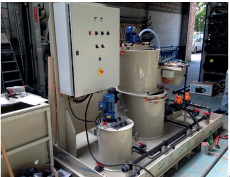
Ce skid de Polymate prépare une solution à base de polymère concentré en émulsion 24h/24 et 7j/7 pour traiter les eaux de process d'une usine de fabrication de caoutchouc spécifique en Normandie.
