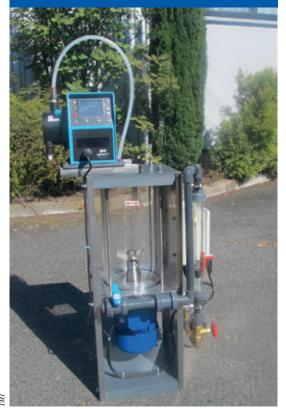
Le Polydos 412-4000 de Grundfos offre une capacité de production de 4 000 l/h, avec un fonctionnement automatique assuré par une sonde à ultrasons quatre niveaux.
