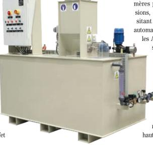
Les Poly Range de Seko sont des systèmes automatiques pour la préparation continue de solutions de polyélectrolytes. Le système de dosage de la solution peut être ajusté de manière flexible à partir d'une large gamme de pompes de dosage.
