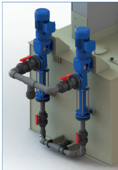
Pompes de soutirage
